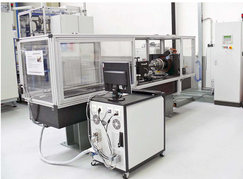
Gelenkprüfstand zur Lebensdauerermittlung
